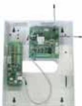
Installazione del modulo uscite logiche PX8 con il ricevitore RTX3 nell'armadio metallico BOX-1 (cod. PX-BOX1).
