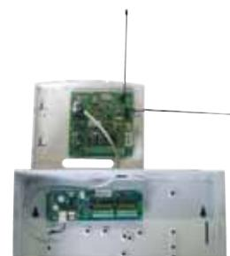
Installazione del modulo uscite logiche PX8 nell'armadio della centrale d'allarme
